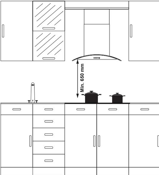
Das Produkt wurde in Übereinstimmung mit handelsüblichen Küchenarbeitsplatten entwickelt. Halten Sie zwischen dem Produkt und Küchenwänden oder -möbeln einen Sicherheitsabstand ein. Falls eine Dunstabzugshaube über dem Gerät installiert wird, beachten Sie bei der Montagehöhe die Anweisungen des Herstellers der Dunstabzugshaube (mindestens 65 cm). Beachten Sie beim Aussägen der Arbeitsplatte die Installationsabmessungen des Kochfeldes.
